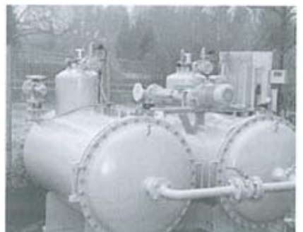
Entöler 2000 „new generation“ <5ppm mit Leistungen von 100l/h bis 10 m 3 /h.
